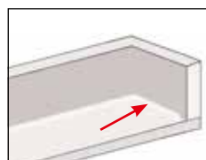
Giunture degli angoli fra massetto e parete
