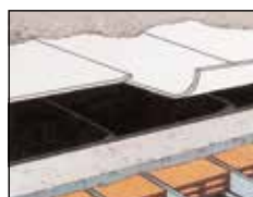
Sopra le membrane bituminose
