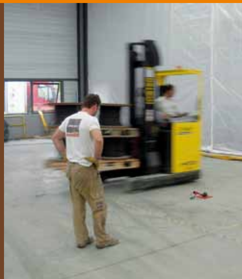
Il comparatore centesimale segnala i movimenti della piastra al passaggio del muletto.
